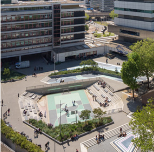
4. Waterplein: berging van regenwater Benthemplein te Rotterdam van de Urbanisten
